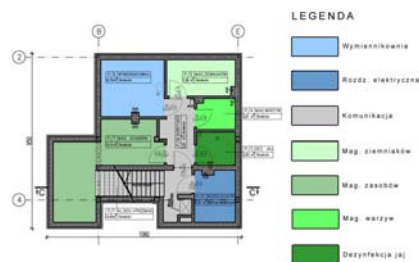
Rys.14. Schemat funkcjonalny kondygnacji „-1” [oprac. autor]: magazyny (zielony), pom techniczne (niebieski)
